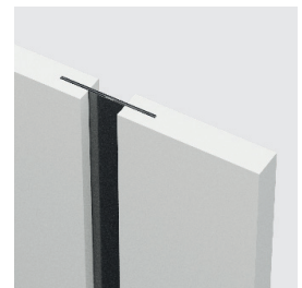
łączenie z szybą „na kant” skrzydło bezprzylgowe
