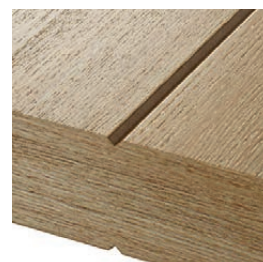
zbliżenie na frezowanie - widoczna struktura podłoża
